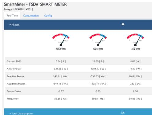
Figure 4. Smart Meter Sensor Web Page
